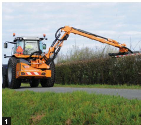
1 et 2. Faucheuses débroussailleuses (côté droit ou gauche) avec portées jusqu'à 7,40 m 3. Distributeurs de sel et de sable
