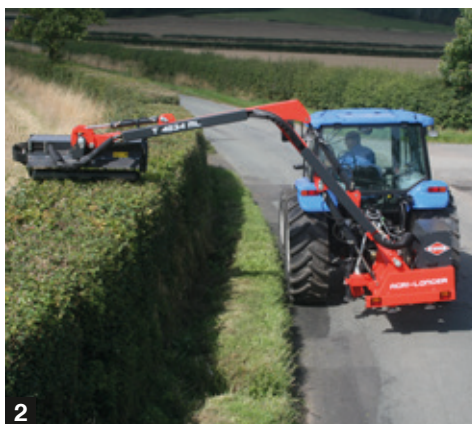
1 et 2. Faucheuses débroussailleuses (côté droit ou gauche) avec portées jusqu'à 7,40 m 3. Distributeurs de sel et de sable
